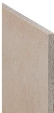
La plaque de plâtre fibrée Rigidur H 18 (type GF-C2-I-W2 selon EN 15283-2) se compose de plâtre, de fibres de cellulose et de matières minérales. Elle est appropriée pour les constructions robustes dans l'aménagement intérieur soumises à des exigences en matière d'isolation acoustique et de protection incendie, ainsi que dans les salles humides des habitats
