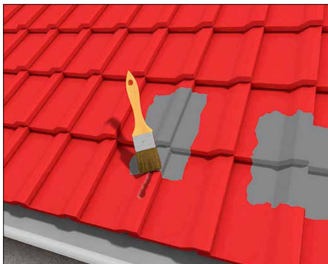
1 Etanchéité et réparation aux tuiles de toitures
