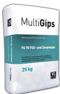
Füllgips auf Basis eines werkgemischten Gips-Trockenmörtels DIN EN 13279 zum Füllen von Deckenanschlussfugen in Bauteilen aus Gips-Wandbauplatten. Auch zum Hinterferfüllen von Zargen in Trennwänden aus Gips-Wandbauplatten.
