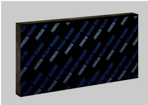
FOAMGLAS® READY BOARD T3+ est un panneau composé de plaques de verre cellulaire FOAMGLAS® T3+ assemblés entre elles. La face supérieure du panneau est pourvue d'un revêtement spécial bitumé, qui permet de poser des lés d'étanchéité par soudure. Sur la face inférieure se trouve un non-tissé blanc.
