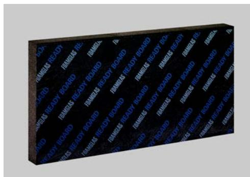
FOAMGLAS® READY BOARD T4+ est un panneau de format 1200 x 600 mm composé de plaques de verre cellulaire FOAMGLAS® T4+ assemblés entre elles. La face supérieure du panneau est pourvue d'un revêtement spécial bitumé, qui permet de poser des lés d'étanchéité par soudure. Sur la face inférieure se trouve un non-tissé blanc.
