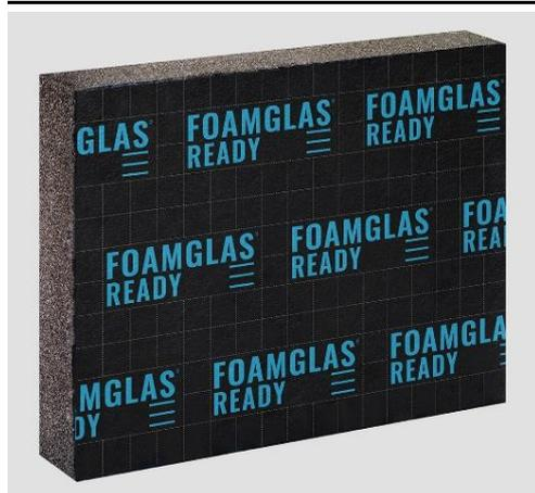
FOAMGLAS® READY T4+ est un panneau de format 600 x 450 mm composé de verre cellulaire FOAMGLAS® T4+. La face supérieure du panneau est pourvue d'un revêtement spécial bitumé, qui permet de poser des lés d'étanchéité par soudure.
