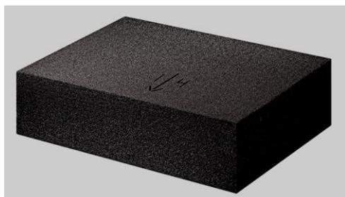
FOAMGLAS® TAPERED S3 est une plaque à pente intégrée composée de verre cellulaire FOAMGLAS® S3. La direction de la pente est indiquée par une flèche, les plaques sont spécialement repérées et numérotées. Les plaques sont fabriquées sur mesure pour chaque projet.
