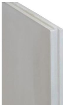
Partie d'ouvrage fabriquée en usine à base de sulfate de calcium et d'eau avec la classe densité apparente M, et qui contient des fibres et des additifs.
