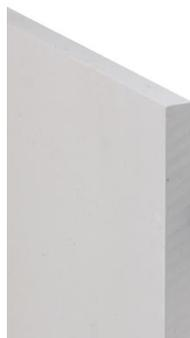
Glasroc F (Ridurit) est une plaque de plâtre armée d'un non-tissé selon EN 15283-1, de type GM-FH2 (ou GM-FH1 pour Riflex 6 mm) avec une capacité d'absorption d'eau réduite et une cohésion de la structure améliorée en cas de températures élevées.
