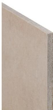
La plaque de plâtre fibrée Rigidur H 10 (type GF-C1-I-W2 selon EN 15283-2) se compose de plâtre, de fibres de cellulose et de matières minérales. Elle est appropriée pour les constructions robustes dans l'aménagement intérieur soumises à des exigences en matière d'isolation acoustique et de protection incendie, ainsi que dans les salles humides des habitats.
